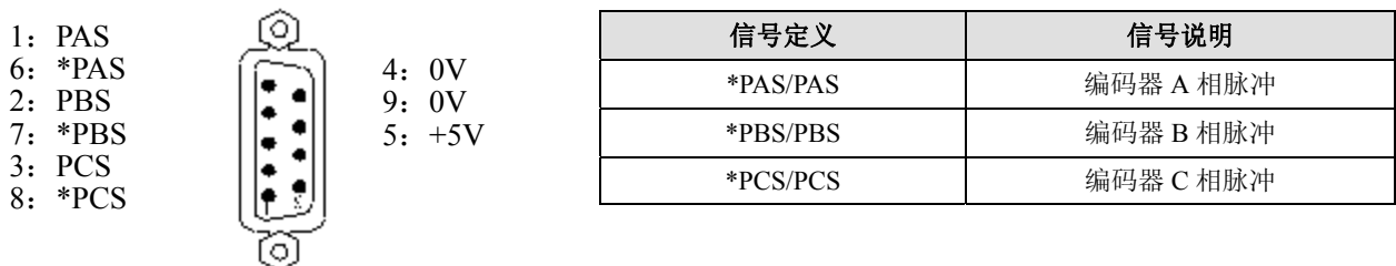
图 2-3-1 CN21、CN22、CN23、CN24 编码器接口 (9 芯 D 型针插座)
