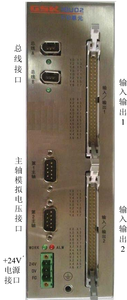
图 1-1 IOL-01F 型号 I/O 单元结构图
