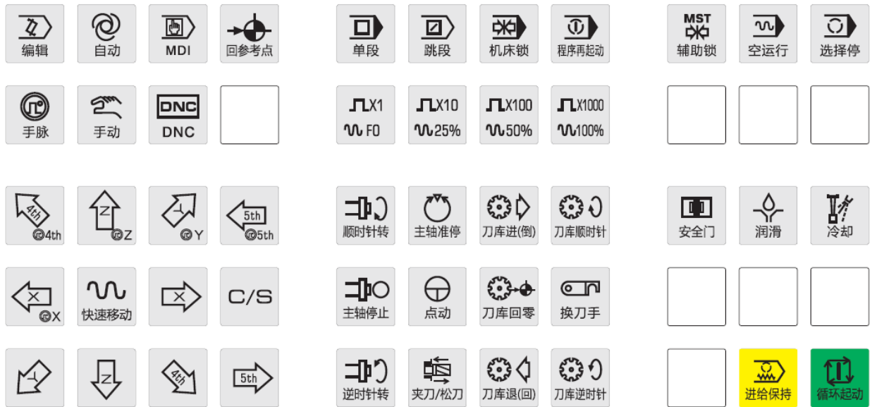
图 5-1-1 988MB 标准机床操作面板布局图
