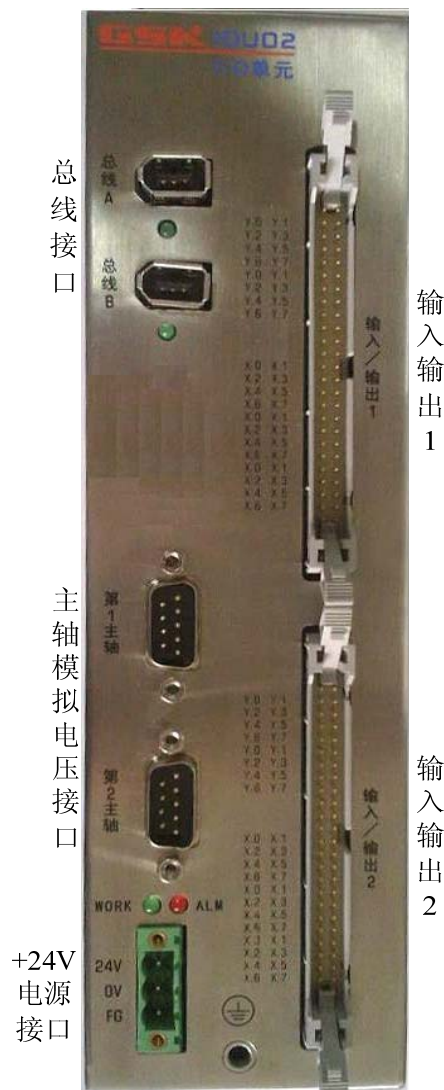
图 2-1 IOL-02F 型号 I/O 单元结构图
